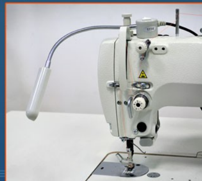
Lampa LDA-20 uniwersalna lampa mocowana do korpusu maszyny za pomocą magnesu
